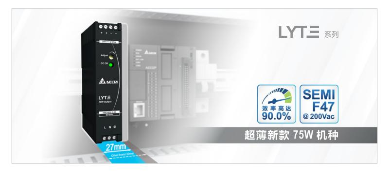
台达推出 Lyte 系列导轨型电源供应器超薄新款 75W 机种,宽度仅 27mm,为系列之最,包含 12V (DRL-12V75W1AZ)、24V (DRL-24V75W1AZ)及 48V (DRL-48V75W1AZ)等输出电压,可方便置入受空间限制的控制箱内。基于自然对流冷却设计,Lyte 系列于 -20°C 至 +70°C 温度范围运行,230Vac 输入下可在 -10°C 至 +50°C 全功率运行,更可于 -30°C 极端条件下冷启动。得益于恒流模式的过流保护设计,使得本产品适合电感负载与电容负载应用。
